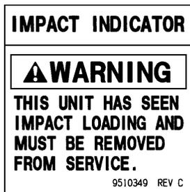
Etiqueta del indicador de impacto: Eslingas de amarre a sí mismas EZ Stop® Shock Wave 2 y eslingas EZ Stop® Shock Wave III
