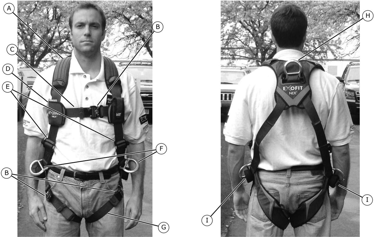
**A.** Tirante del hombro con protector híbrido **B.** Hebilla de conexión rápida Duo-Lok™ **C.** Correa del pecho **D.** Correa del pecho híbrida con etiqueta de RFID i-Safe™ RFID y etiquetas **E.** Ajuste del torso Revolver™ **F.** Anillo "D" lateral Tech-Lite™ **G.** Correa de la pierna **H.** Anillo "D" dorsal Tech-Lite™ **I.** Correa para traumatismos
